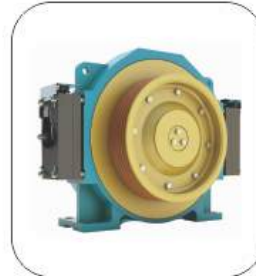
FUJI: FK200 Tải trọng / Load 630 - 1150kg Công suất / Power 2.2 - 15kw Tốc độ / Speed 0.5 - 2.0m/s Điện áp / 3 phase 380VAC - 50hz
