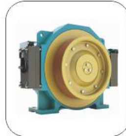
FUJI: FK200 Tải trọng / Load 630 - 1150kg Công suất / Power 2.2 - 15kw Tốc độ / Speed 0.5 - 2.0m/s Điện áp / 3 phase 380VAC - 50hz
