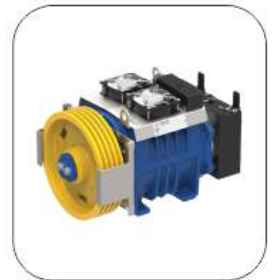
MONTANARI: MG SERIES MG200, MG34, MG19, MG25, MG30, MG34, MG19, MGX75, MGX80 Tải trọng / Load 300 - 6000kg Công suất / Power 1.1 - 60kw Tốc độ / Speed 0.5 - 4.0m/s Điện áp / 3 phase 380VAC - 50hz
